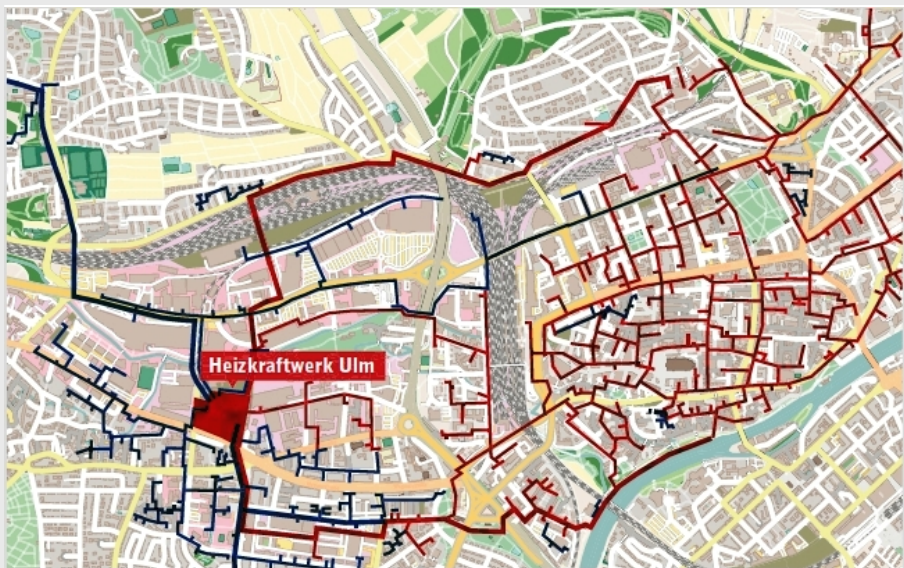
Abb.15: Ausschnitt des Fernwärmenetzplans Ulm
